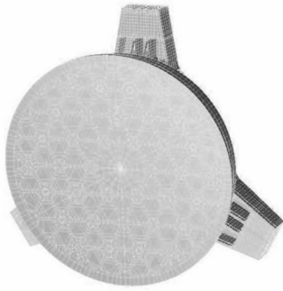
图 3 主反射镜组件的有限元模型
